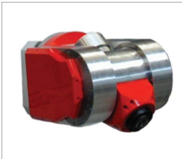
■ Aplicación real de 4 motores gearless Parker STK accionando 3 ejes de una fresadora. Esta concepción compacta hubiese sido inviable usando reductores, debido al espacio ocupado y a las masas intermedias adicionales en los 3 ejes.
